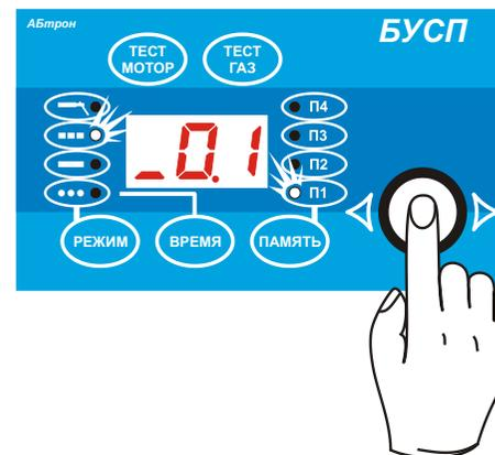
Нажатие кнопки “ПУСК” на горелке - блок запомнит параметр.
